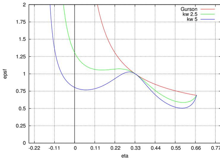
Fig. 3 Gurson-Hutchinson failure curve for different values of parameter  $k_\omega$
